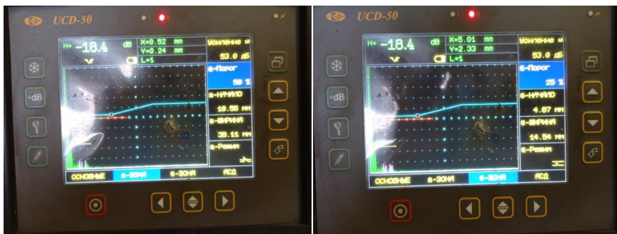
Рис. 9 Установка браковочного уровня и уровня фиксации
