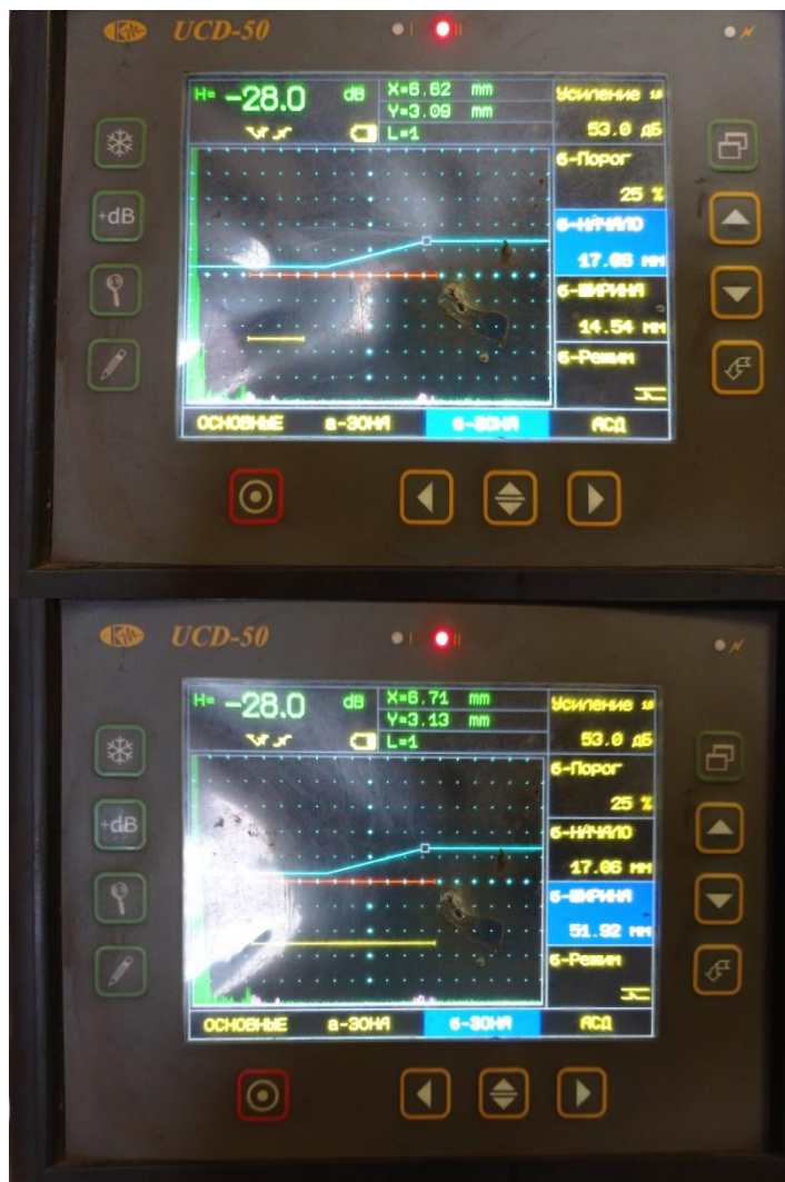
Рис. 14 Установка начала и ширины уровня фиксации
