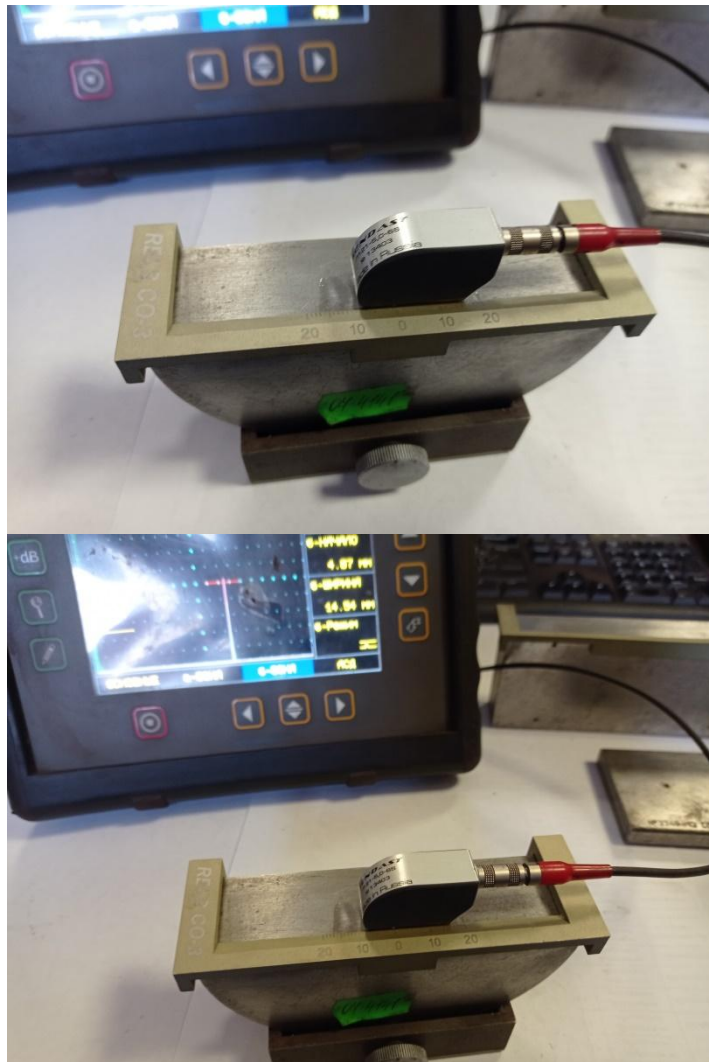
Рис. 5 Определение точки выхода луча преобразователя
