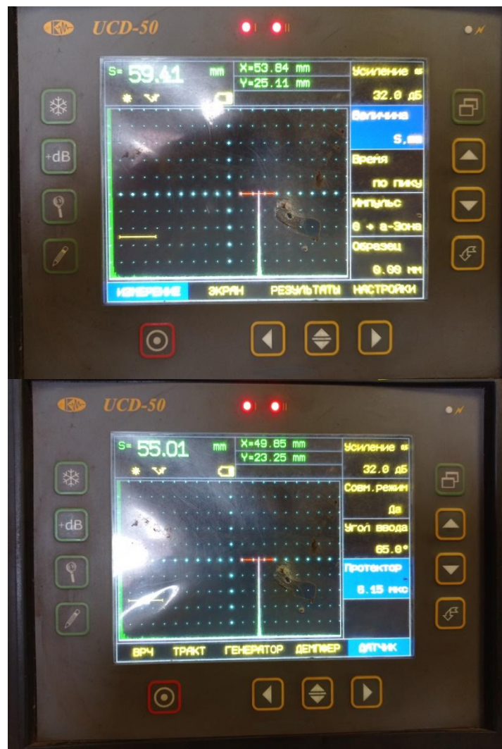
Рис. 6 Определение задержки в призме преобразователя
