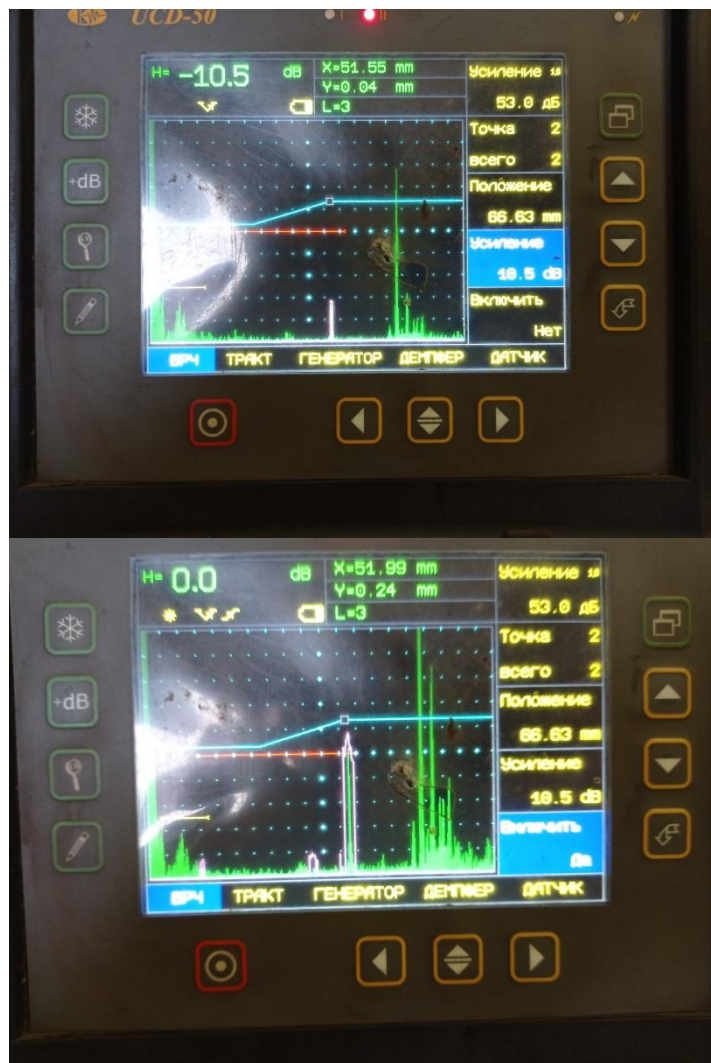
Рис. 12 Определение второй точки ВРЧ
